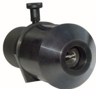
Das Lochwerkzeug besteht aus der Stempereinheit und dem Matrizenhalter; der Locheinsatz aus Lochstempel und Matrize. Der Lochstempel ist mit einer Zentrierspitze ausgestattet, die eine schnelle und exakte Positionierung ermöglicht.
